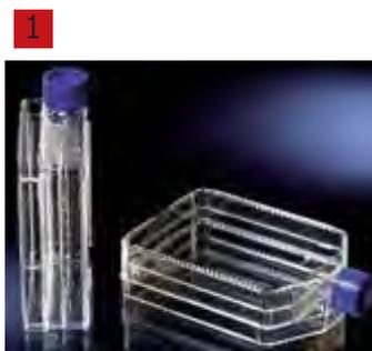
**1** Fiasche per colture cellulari TripleFlask, Superficie Nunclon™Δ, PS/PE-HD, sterili
