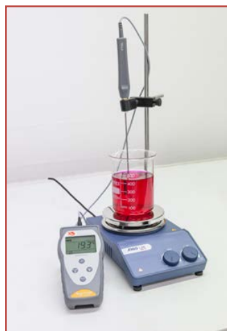
Misura della temperatura di liquidi
