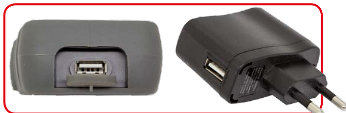
Uscita USB per scarico dati ed alimentazione tramite PC o alimentatore a rete fornito di serie
